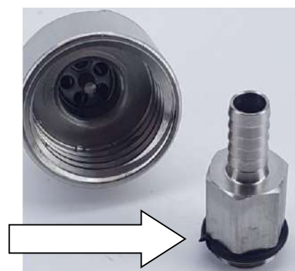
Повреждённое уплотнительное кольцо
